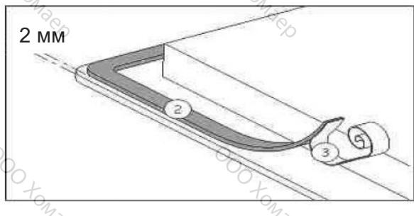
Снимите защитную ленту (3) и уложите уплотнение (2) по внешнему краю стеклянной поверхности так, чтобы оставался зазор ок. 2 мм.
